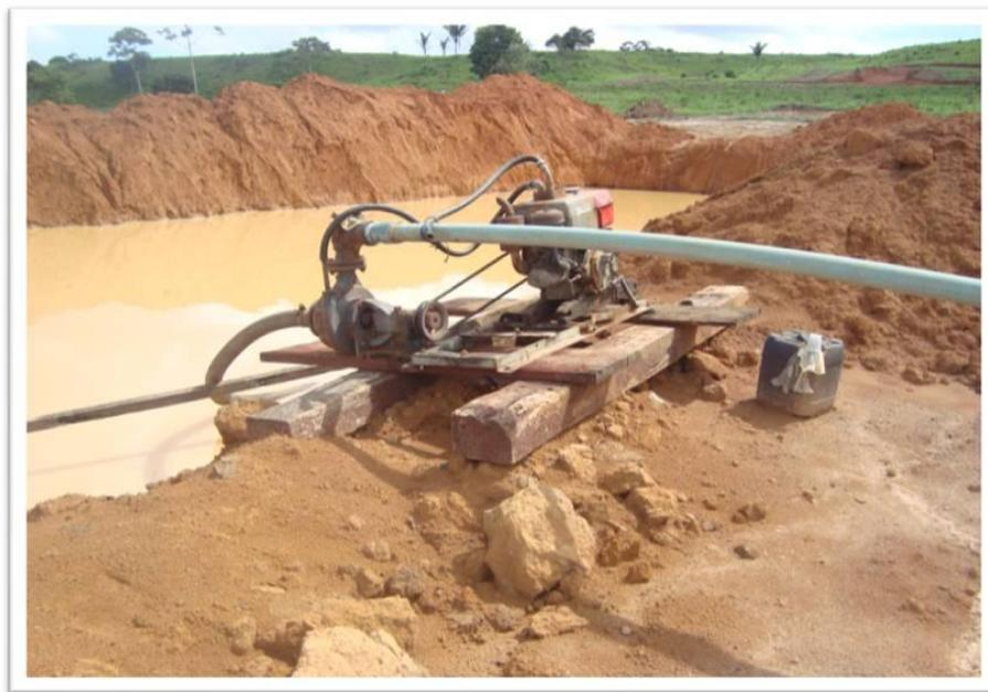
Figura 34 - Uso de draga para ampliação/escavação de tanques.
